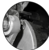
Imagen 18. Desgaste del freno trasero.
