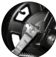
Imagen 17. Desgaste del freno delantero.
