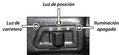
Imagen 2. Interruptor de luz delantera
