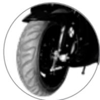
Imagen 21. Llanta en buenas condiciones.
