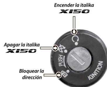
Imagen 6. Interruptor de encendido y bloqueo.
