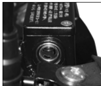
Imagen 21. Nivel del líquido del freno delantero.
