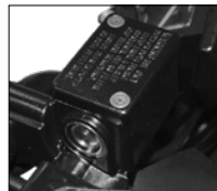
Imagen 22. Completar el nivel del líquido del freno delantero.
