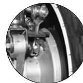
Imagen 20. Desgaste del freno trasero.
