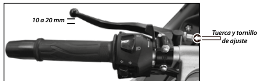
Imagen 19. Ajuste de la palanca del embrague.
