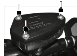
Imagen 17. Completar el nivel de líquido de freno.
