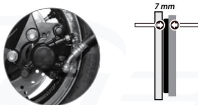
Imagen 12. Desgaste del freno delantero.
