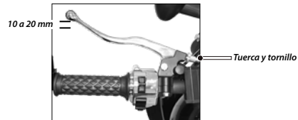
Imagen 22. Ajuste de la palanca del embrague.
