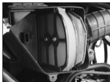
Imagen 20. Filtro de aire.
