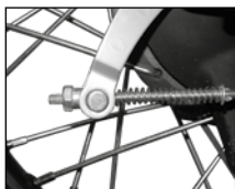
Imagen 23. Ajuste del pedal del freno trasero.
