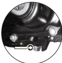
Imagen 17. Ubicación del tornillo de drenado.
