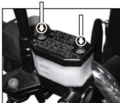
Imagen 25. Completar el nivel del líquido de freno.
