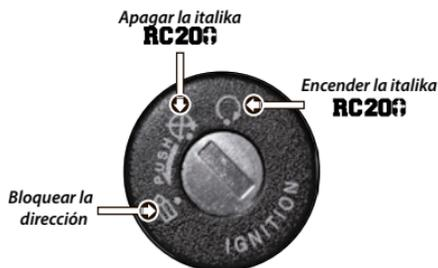
Imagen 9. Interruptor de encendido y bloqueo.
