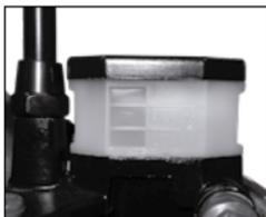
Imagen 24. Nivel del líquido de freno delantero.
