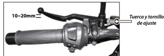
Imagen 21. Ajuste de la palanca del embrague.
