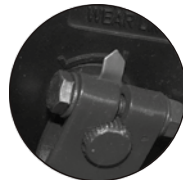
Imagen 23. Indicador de desgaste del freno trasero.
