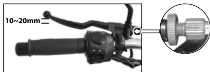
A B Imagen 20. Ajuste de la palanca del embrague.
