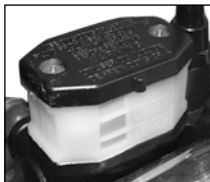
Imagen 26. Completar el nivel del líquido de freno.
