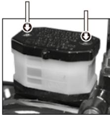
Imagen 26. Completar el nivel del líquido de freno.
