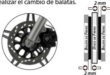
Imagen 22. Desgaste del freno delantero.
