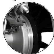
Imagen 20. Desgaste del freno trasero.
