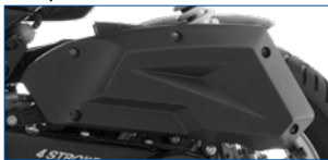
Imagen 17. Filtro de aire.
