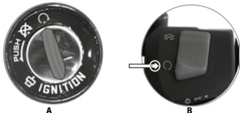
Imagen 30. Encendido del motor.
