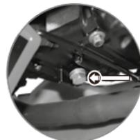
Imagen 15. Ubicación del tornillo de drenado.
