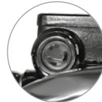
Imagen 24. Nivel del líquido del freno delantero.
