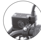
Imagen 27. Nivel del líquido del freno delantero.
