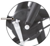
Imagen 22. Indicador de desgaste del freno delantero.
