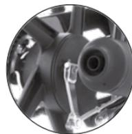
Imagen 23. Indicador de desgaste del freno trasero.
