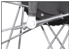
Imagen 25. Ajuste del pedal del freno trasero.
