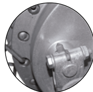
Imagen 24. Indicador de desgaste del freno trasero.
