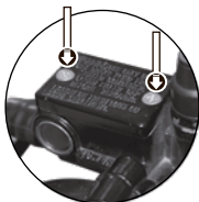
Imagen 27. Completar el nivel del líquido de freno.
