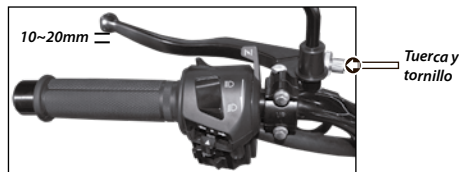
Imagen 21. Ajuste de la palanca del embrague.
