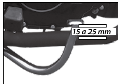
Imagen 25. Ajuste del pedal del freno trasero.
