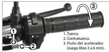
Imagen 18. Ajuste del puño del acelerador.
