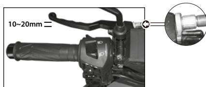
A B Imagen 20. Ajuste de la palanca del embrague.
