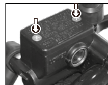
Imagen 25. Completar el nivel del líquido de freno.
