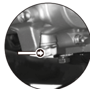
Imagen 16. Ubicación del tornillo de drenado.
