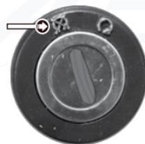
Imagen 30. Apagado de motor.
