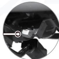
Imagen 15. Ubicación del tornillo de drenado.
