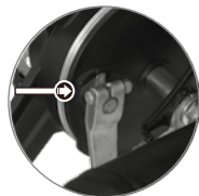
Imagen 22. Indicador de desgaste del freno trasero.
