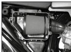
Imagen 17. Filtro de aire.
