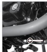
Imagen 15. Ubicación del tornillo de drenado.
