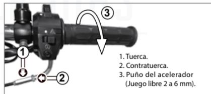
Imagen 18. Ajuste del puño del acelerador.
