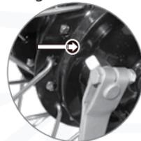
Imagen 22. Indicador de desgaste del freno trasero.
