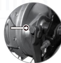
Imagen 20. Indicador de desgaste del freno delantero.
