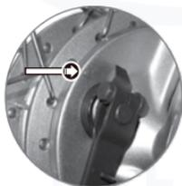
Imagen 21. Indicador de desgaste del freno trasero.
