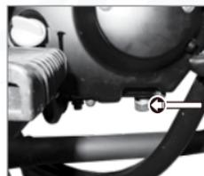
Imagen 15. Ubicación del tornillo de drenado.
