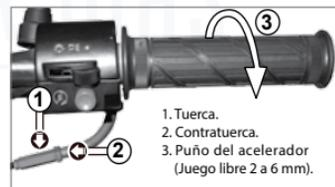
Imagen 18. Ajuste del puño del acelerador.
