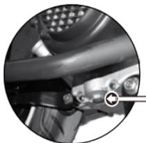
Imagen 13. Ubicación del tornillo de drenado.
