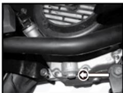
Imagen 13. Ubicación del tornillo de drenado.
