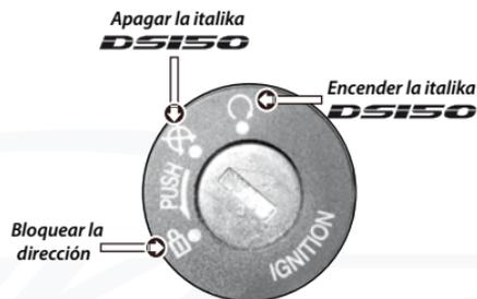
Imagen 6. Interruptor de encendido y bloqueo.
