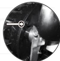
Imagen 17. Desgaste del freno delantero.
