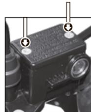
Imagen 24. Completar el nivel de líquido de freno delantero.
