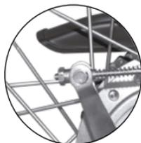
Imagen 22. Ajuste del pedal del freno trasero.
