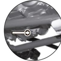
Imagen 14. Ubicación del tornillo de drenado.
