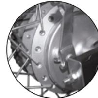
Imagen 21. Indicador de desgaste de freno trasero.
