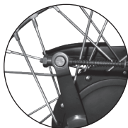
Imagen 22. Ajuste del pedal del freno trasero.
