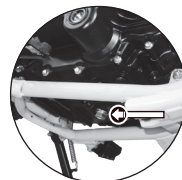
Imagen 14. Ubicación del tornillo de drenado.
