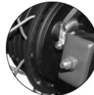
Imagen 25. Indicador de desgaste del freno trasero.
