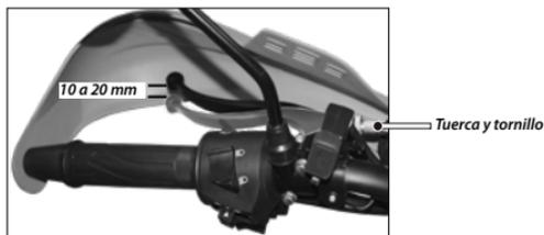
Imagen 22. Ajuste de la palanca del embrague.
