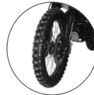
Imagen 32. Llanta en buenas condiciones.
