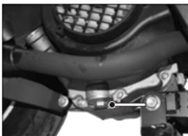
Imagen 14. Ubicación del tornillo de drenado.
