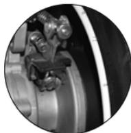
Imagen 19. Desgaste del freno trasero.
