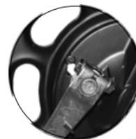
Imagen 18. Desgaste del freno delantero.
