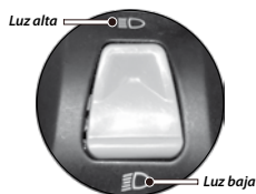
Imagen 4. Interruptor de cambio de luz.
