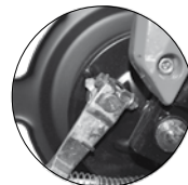
Imagen 18. Desgaste del freno delantero.
