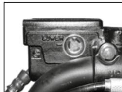
Imagen 27. Nivel de líquido de los frenos delanteros.
