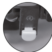
Imagen 7. Interruptor de arranque eléctrico.
