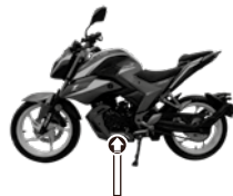
Imagen 15. Ubicación del tornillo de drenado.
