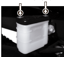
Imagen 26. Completar el nivel de líquido de freno trasero.
