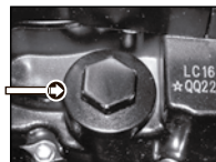
Imagen 15. Ubicación del tornillo de drenado.
