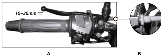
Imagen 19. Ajuste de la palanca del embrague.
