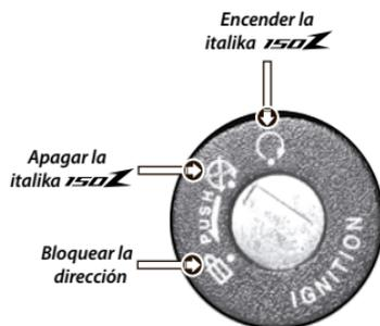
Imagen 9. Interruptor de encendido y bloqueo.
