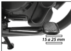
Imagen 24. Ajuste del pedal del freno trasero.
