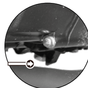
Imagen 16. Ubicación del tornillo de drenado.
